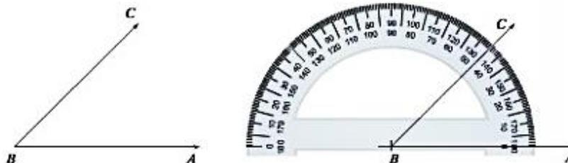
Se coloca el transportador de modo que coincida el centro con el vértice del ángulo, y la  $\overrightarrow{BA}$  indique el 0°. Luego, se observa la medida que indica la  $\overrightarrow{BC}$ .
